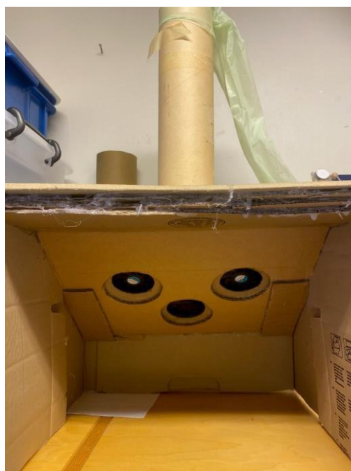
Billede 1: Udsugningsboks af papkasse med sug bygget af udluftsfaner fra gamle computere
